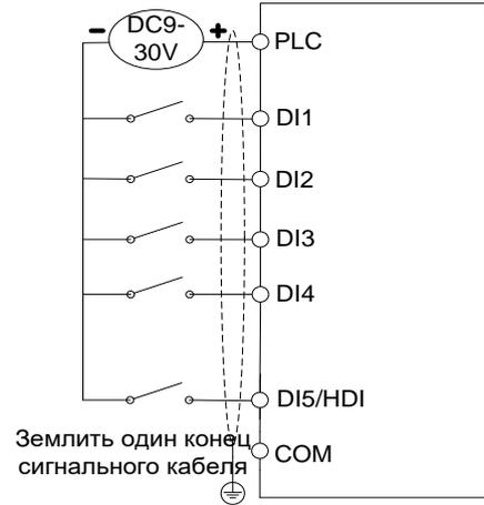
Подключение входов типа «открытый коллектор PNP» со встроенным источником питания +24В
