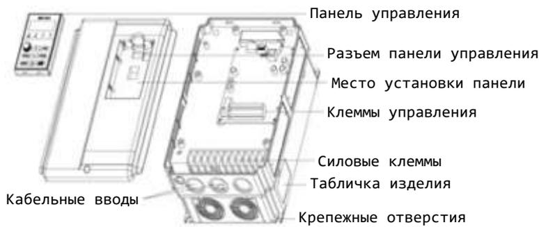
*Модели мощностью от 5,5 кВт до 15 кВт*
