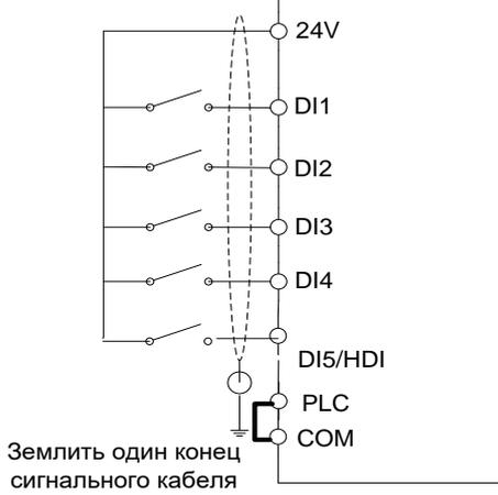
Подключение входов типа «открытый коллектор PNP» с внешним источником питания +24В
