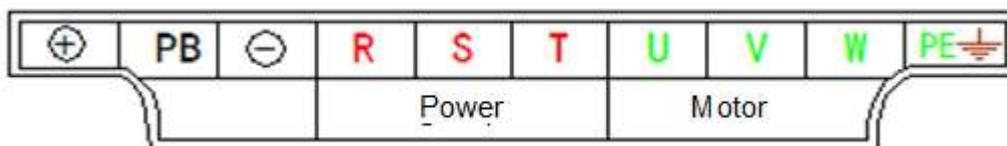
Схема расположения клемм на ПЧ 5,5~15 кВт 380 В
