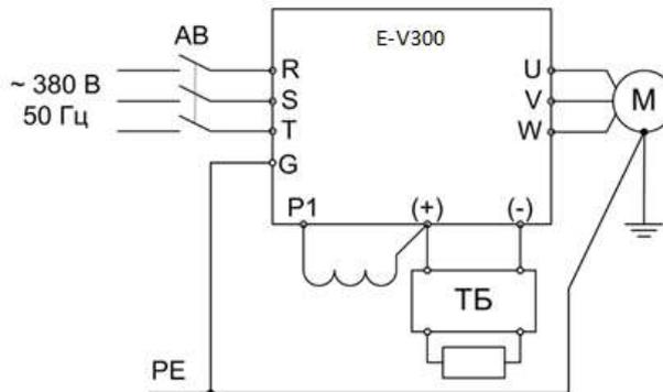
Подключение ПЧ 380 В 55 кВт и выше с тормозным резистором, подключенным через тормозной блок и дросселем постоянного тока
