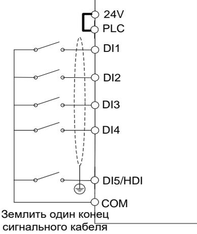
Подключение входов типа «открытый коллектор NPN» с внешним источником питания +24В
