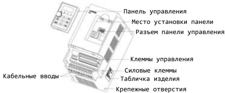
*Модели мощностью до 3,7 кВт*
