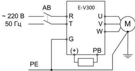
Подключение ПЧ 220 В 0,2~0,4 кВт с тормозным резистором
