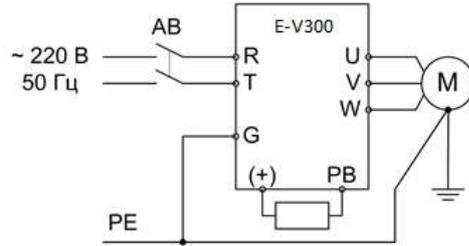
Подключение ПЧ 220 В 0,75~2,2 кВт с тормозным резистором
