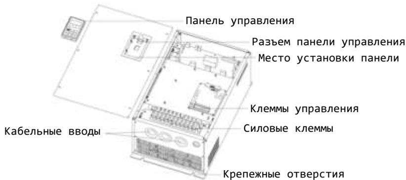
*Модели мощностью от 18 кВт до 45 кВт*
