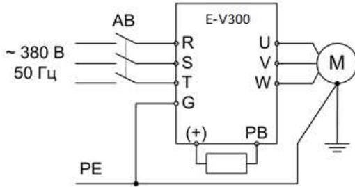
Подключение ПЧ 380 В 0,4~3,7 кВт с тормозным резистором
