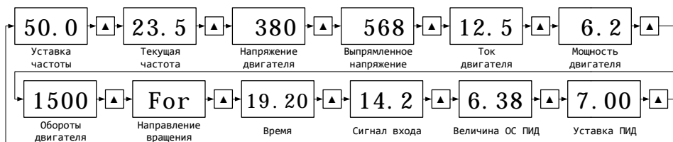
Рисунок 29 – Просмотр параметров состояния ПЧ
