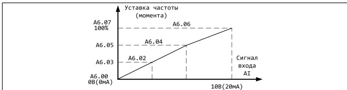
Рис. 7-20 – График зависимости частоты (момента) от сигнала на аналоговых входах при использовании характеристики 4
