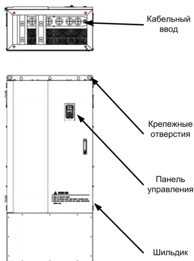
Рисунок 5-3 – Модели мощностью от 45 кВт (модификация G), от 55 кВт (модификация P) и выше (шкафное исполнение)
