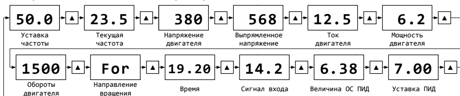
Рисунок 25 – Просмотр параметров состояния ПЧ
