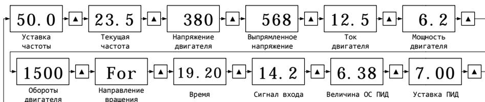
Рисунок 30 – Просмотр параметров состояния ПЧ
